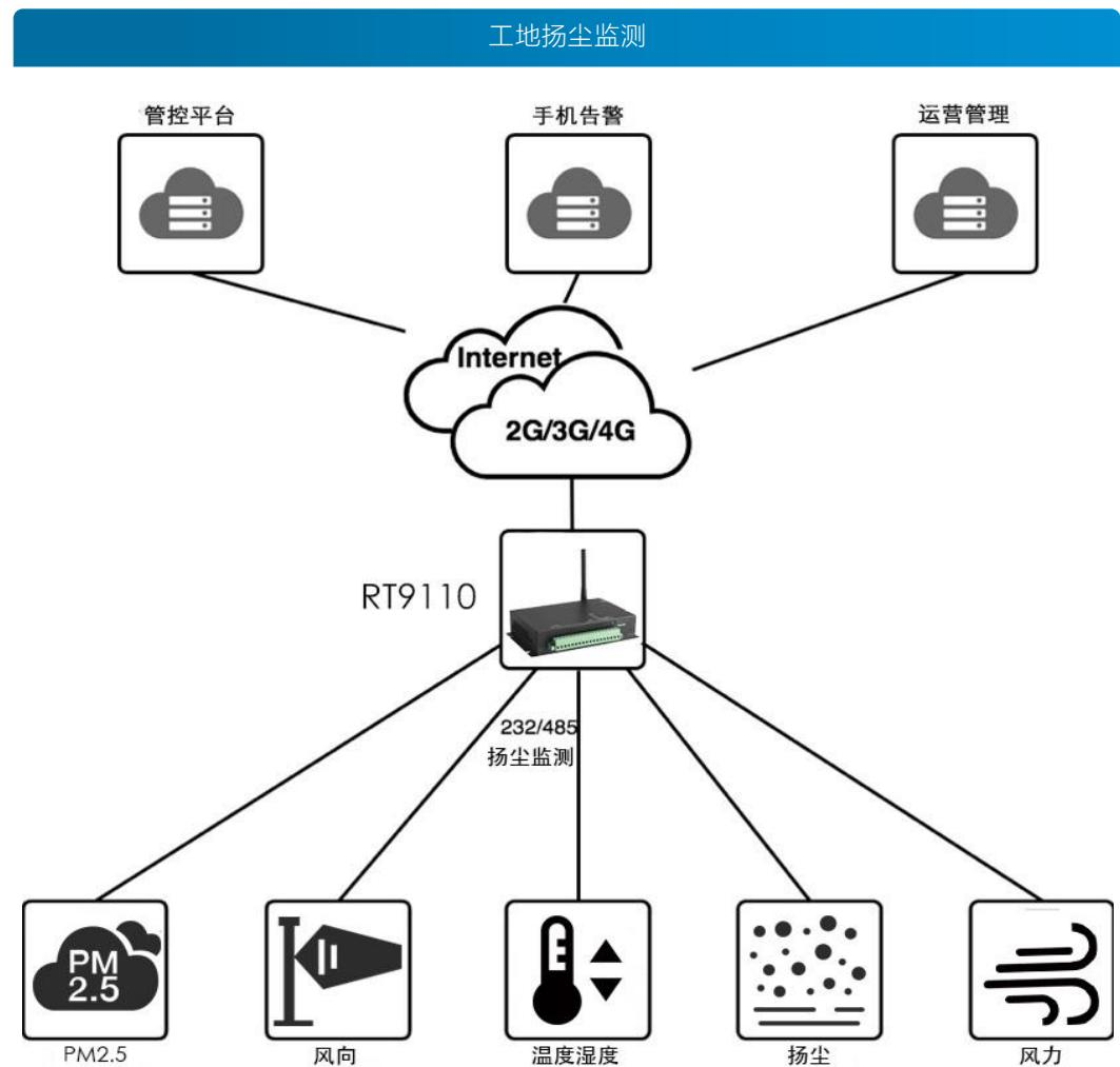
工地扬尘监控解决方案中，RT9110系列工业级RTU解决工地扬尘监控中各种物联网数据的采集传输。实现了PM2.5,风速风力，风向，扬尘PM2.5，温度湿度，等多监测因子数据的统一接入，智能采集控制和集中管理，助力智慧城市发展建设，为城市环境美化带来新的发展。
